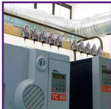
Controllo temperatura per mappatura stufe da laboratorio
